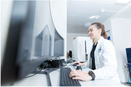
Bild 1: Beispiel eines REM-Arbeitsplatzes: Das REM-EDX-Tischgerät ist der weiße Würfel im Hintergrund, die Auswertung erfolgt an einem „Curved Monitor“ (Bild: Tobias Ehmer)
