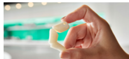
Bild 5: Die einzelnen Glieder eines Fingers aus PC-ABS werden durch Gelenke aus weichem TPE (Sh 30 A) beweglich (Bild: ARBURG)
