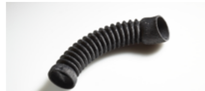
Bild 2: Im AKF-Verfahren wurde aus dem TPU Desmopan 9370 AU (Härte 70 Sh A) der Prototyp eines Verbindungsschlauchs für Pkw-Kühlsysteme gefertigt (Bild: ARBURG)
