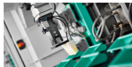
Bild 6: Betriebsmittel in Hart-Weich-Verbindung: Der Freeformer kann z. B. individuelle Zwei-Komponenten-Greifer für Robot-Systeme additiv fertigen (Bild: ARBURG)
