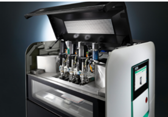
Bild 1: Der Freeformer 300-3X verfügt über drei Austrageinheiten. Damit lassen sich z. B. komplexe und belastbare Funktionsbauteile aus TPE und in Hart-Weich-Verbindung herstellen (Bild: ARBURG)
