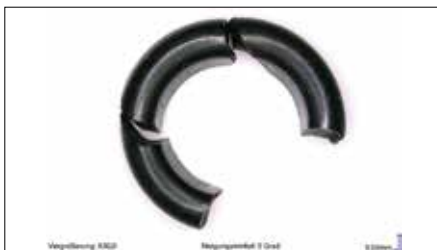
Bild 2: Überhitzter NBR O-Ring, vorgesehen in dieser Anwendung war ein FKM-Werkstoff (Bild: O-Ring Prüflabor Richter GmbH)
