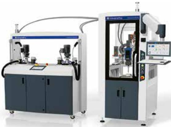
**Bild 1: Bewährte Systemlösung für den Verguss unter Atmosphäre**
