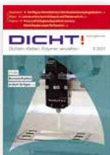
Dosierung einer hochabrasiven 1K-Glaslot Paste auf Interkonnektoren mit einem ViscoTec RD Dispenser
