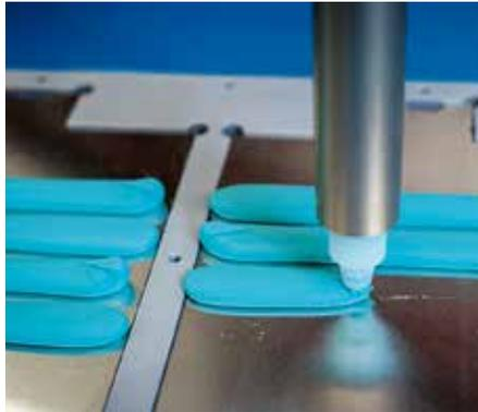
**Bild 1: Moderne Thermal-Interface-Materialien wie DuPont™ BETATECH™ 2090 tragen erheblich zur Sicherheit von E-Fahrzeugen bei (Bild: DuPont)**
