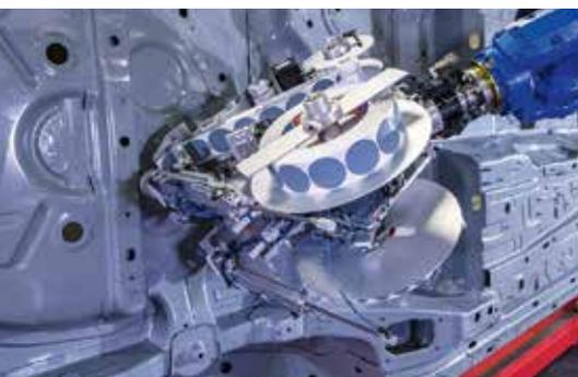
**Bild 2: Der automatisierte Klebepad-Auftrag ist flexibel gestaltbar und wirtschaftlich interessant**
