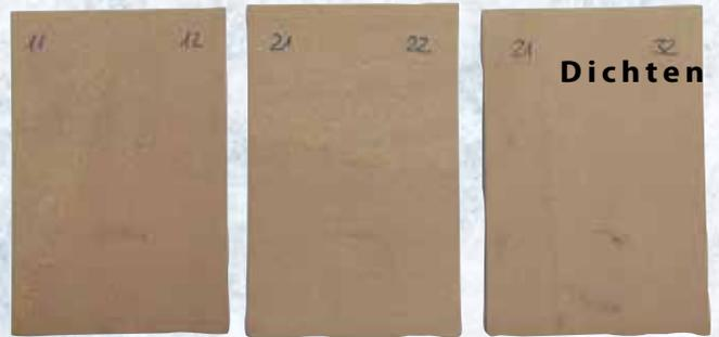
Bild 3: Optische Überprüfung novapress® 850 nach 14 Tagen Einlagerung in R32 mit Kompressoröl BSE 32 bei 14 bar Druck: Das Material hält den Bedingungen vollkommen unbeschädigt stand (Bild: Frenzelit GmbH)
