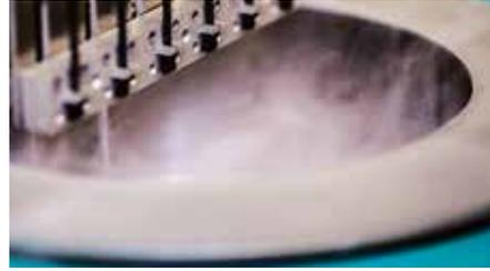
**Bild 2: TR 10-Prüfung: Einfahren der gedehnten Probekörper in das Kältebad (Bild: O-Ring Prüflabor Richter GmbH)**
