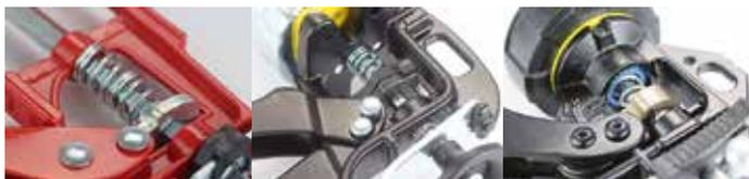
**Bild 2: Beispiele für gebräuchliche Schubklötze – ein zentrales Qualitätskriterium (links: sehr dünne Schubplatte, Mitte: zwei dünne, gehärtete Schubplatten, rechts: gesinterte Hartmetall-Schubplatte)**
