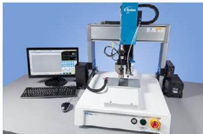
**Bild 3: Automatisierte 3-Achsen-Flüssigkeitsdosierroboter vereinfachen die Programmierung von Punkten, Linien, Kreisen, Bögen, zusammengesetzten Bögen und Mustern auf verschiedenen Ebenen** (Bild: Nordson EFD)
