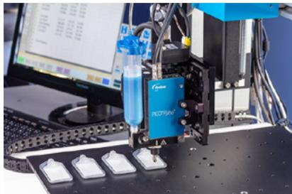
**Bild 1: Manuelle Dosierung von Montageflüssigkeit auf einen Katheter mit einem UltimusPlus Flüssigkeitsdispenser**
