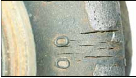
Bild 1: Manschette aus Polyesterurethan (AU) mit Ermüdungsrissen (20-fache Vergrößerung) (Bild: O-Ring Prüflabor Richter GmbH)
