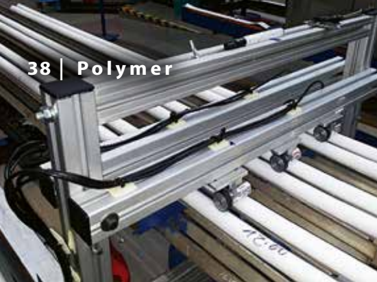
Bild 1: Die Überwachung der Extrusionsgeschwindigkeit ist eine Voraussetzung für konstante Qualität (Bild: Beichler + Grünewald GmbH)
