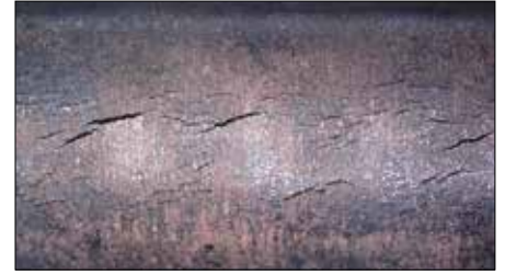
Bild 3: Ozonrisse an einem NBR-Schlauch (Bild: O-Ring Prüflabor Richter GmbH)
