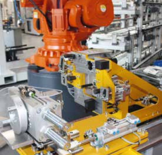
Bild 1: Umsetzung des Konzeptes – im Vordergrund die Fügeeinheit, dahinter Roboter und automatische Lager- und Zuführeinheit (Bild: DoBoTech AG)
