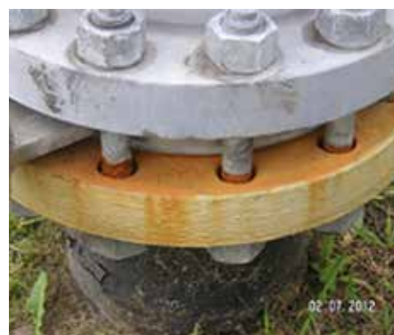
Bild 1: Korrosion an Schraubverbindungen in den unteren Löchern waagerechter Flansche in Außenanlagen (Bild: Peter Thomsen)
