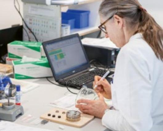
**Bild 2: Vorbereitung einer runden DVR-Prüfform zur Einlagerung in Medien im Becherglas**
