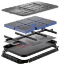
Beim Cell-to-Pack-Verfahren von modernen Batterien kommen beispielsweise thermisch leitende Klebstoffe zum Einsatz, die nicht nur für eine sicherere Verbindung sorgen, sondern gleichzeitig auch die Wärme ableiten (Bild: Henkel AG & Co. KGaA)
