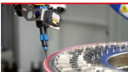
Automatisierter Auftrag von SpeedMask® auf einem Triebwerksbauteil (Bild: MTU Aero Engines)
