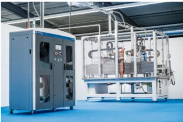
Bild 1: PailFeed-System PFA2001 sorgt für maximale Geschwindigkeit des Dosiersystems (Bild: Scheugenpflug GmbH)
