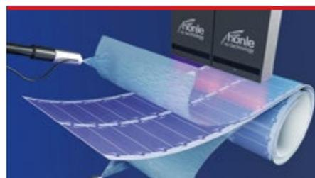
Zur Versiegelung der empfindlichen OPV-Module werden Klebstoffe auf die Barrierefolie aufgetragen (Bild: Panacol)
