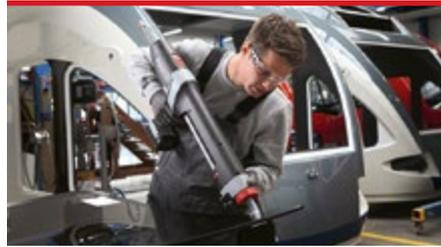
Sikaflex PowerCure Klebstoffsysteme für die Scheibenverklebung in Nutzfahrzeugen mit der Purform-Technologie (Bild: Sika Deutschland GmbH)
