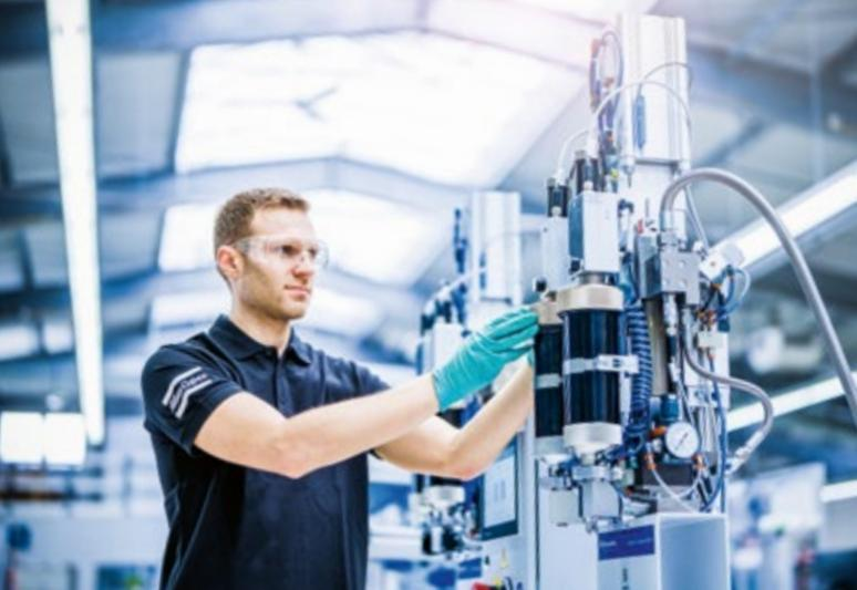
Bild 3: BoostedCartridgeFeed – die ideale Lösung für geringe Materialmengen, die mit hoher Performance dosiert werden müssen (Bild: Scheugenpflug GmbH)
