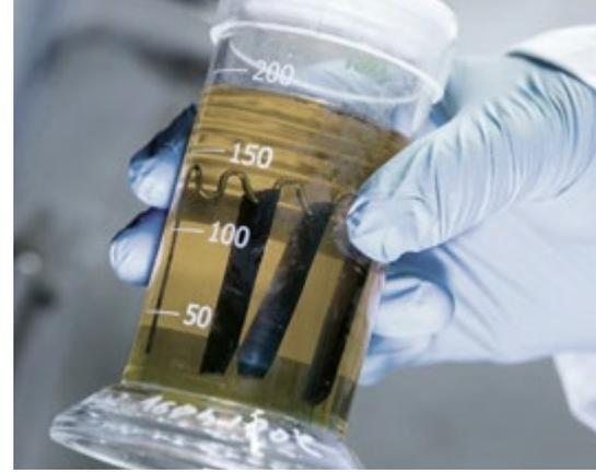
Bild 1: Einlagerungsgefäß mit vorbereiteten Probekörpern für die Messung des Weiterreißwiderstandes nach ISO 34-1 (Streifenprobe)
