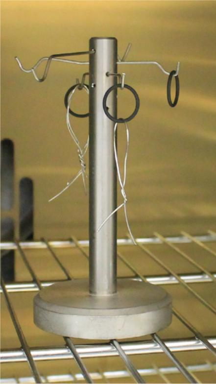
»17 Heißluftalterung an O-Ringen: Durch die vereinzelt Aufhängung wird eine Kontaktmigration von Inhaltsstoffen zwischen den Ringen vermieden. Die gebogenen Drähte an den O-Ringen dienen zur Unterscheidung (Bild: O-Ring Prüflabor Richter GmbH)
