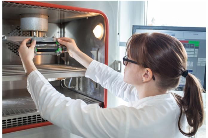
»27 Bestückung eines Ozonprüfschranks im O-Ring Prüflabor Richter
