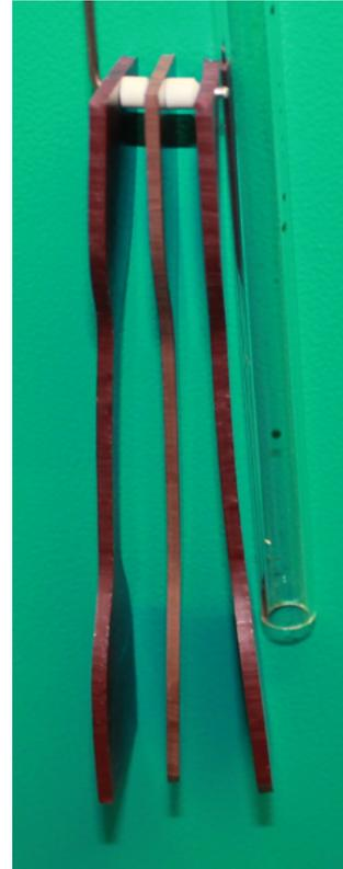
»19 Die weißen Keramikringe dienen als Distanzhalter, um eine Migration von Inhaltsstoffen zu vermeiden (Bild: O-Ring Prüflabor Richter GmbH)
