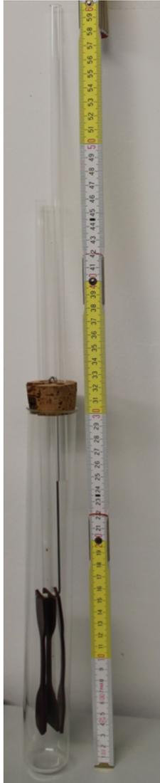
»18 Mit drei ASTM Probekörpern „C bestückte“ Zelle (= Borsilikatglasröhre) nach ASTM D865 (Bild: O-Ring Prüflabor Richter GmbH)
