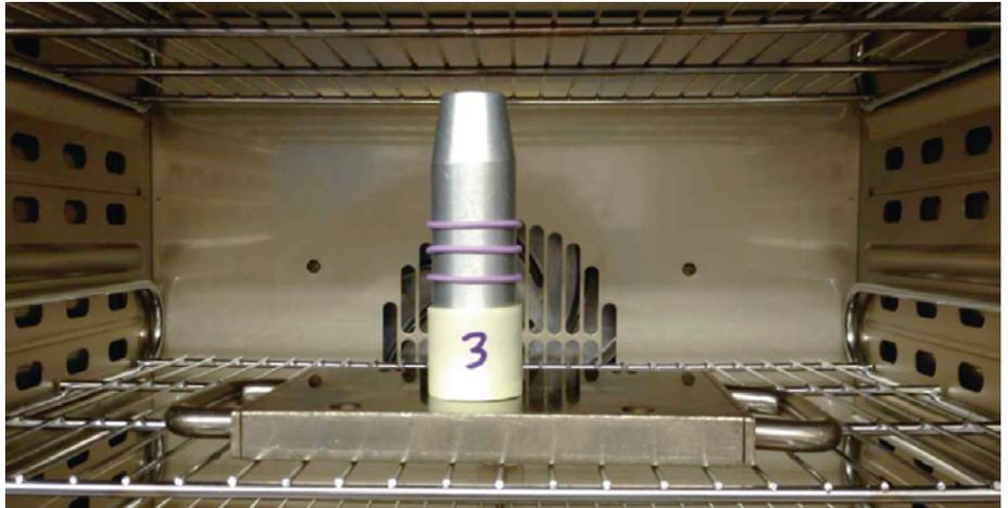
»9 Prüfdorn mit O-Ringen bei der ZVR-Prüfung (Bild: O-Ring Prüflabor Richter GmbH)
