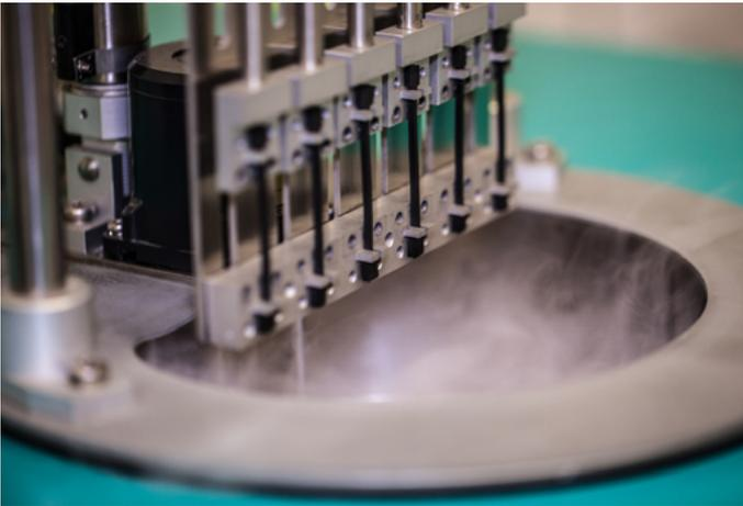
»26 TR10-Prüfung im O-Ring Prüflabor Richter
