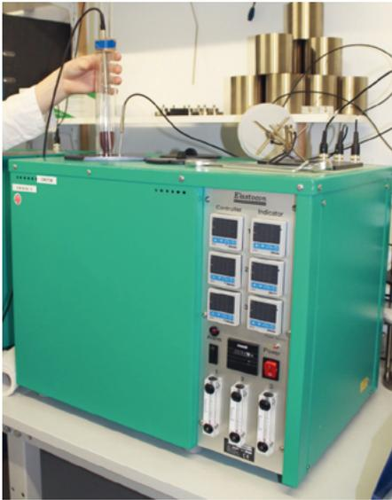
»16 Einführen der Zelle (= Borsilikatglasröhre) in den Zellenofen (Bild: O-Ring Prüflabor Richter GmbH)
