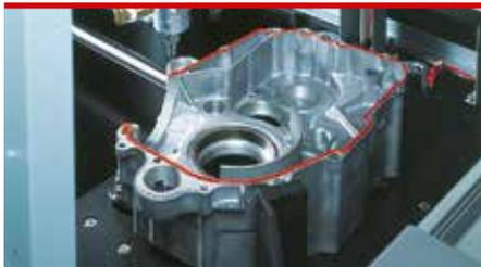
Dichtmittelauftrag auf einem Automotive-Bauteil
