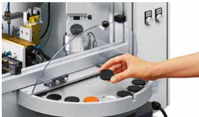
**Manuelle Beladung mit Prüfkörpern für die automatisierte Prüfung**
