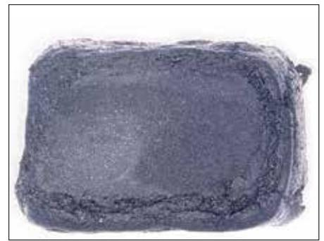
**Bild 3:** EPDM-Werkstoff für den Lebensmitteleinsatz, der durch ungeeignete Füllstoffe bei der Dampfsterilisation angequollen und im Randbereich sogar depolymerisiert wurde
