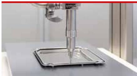
Selbst bei dem einfachen Auftrag einer geschlossenen Dosierraupe sind viele Aspekte zu berücksichtigen (Bild: ViscoTec Pumpen- u. Dosiertechnik GmbH)
