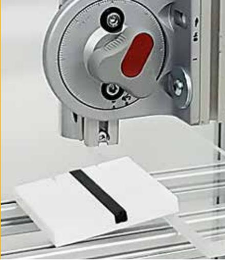
**Bild 1: Überwachung der Aushärtung einer Dichtmasse mittels luftgekoppelten Ultraschalls im Labormaßstab**
