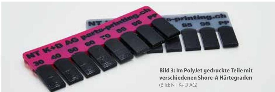
**Bild 3: Im PolyJet gedruckte Teile mit verschiedenen Shore-A Härtegraden**
