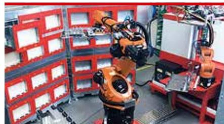
Individualisierte, automatisierte Anlage für das Vergießen von elektronischen Komponenten
