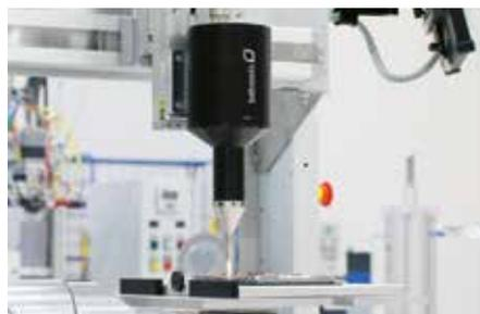
**Bild 1: Plasmavorbehandlung vor dem Kleben erhöht die mechanische Festigkeit der Klebverbindung (Bild bdtronic GmbH)**
