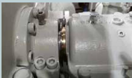
**Bild 3: Man kann die Dichtungen verschrauben, einpressen oder einkleben**
