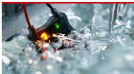
Eine mit LED bestückte Leiterplatte wasserdicht vergossen mit Low Pressure Moulding
