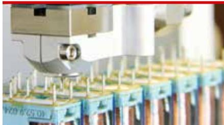
Versiegelung von Relaiskontakten mit einer speziellen Kapillardüse (Bild: perfectdos GmbH)
