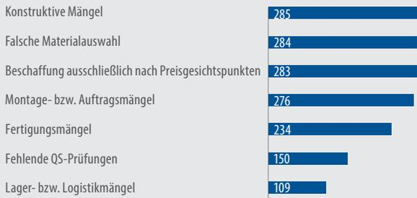
**Bild 14: Konstruktive Mängel, falsche Materialwahl und Beschaffung nach Preiskriterien führen dieses Ranking quasi auf Augenhöhe an. Zum Glück gibt es für alle drei Aspekte bewährte Lösungen und Vorgehensweisen in der Praxis.** (Bild: ISGATEC GmbH)
