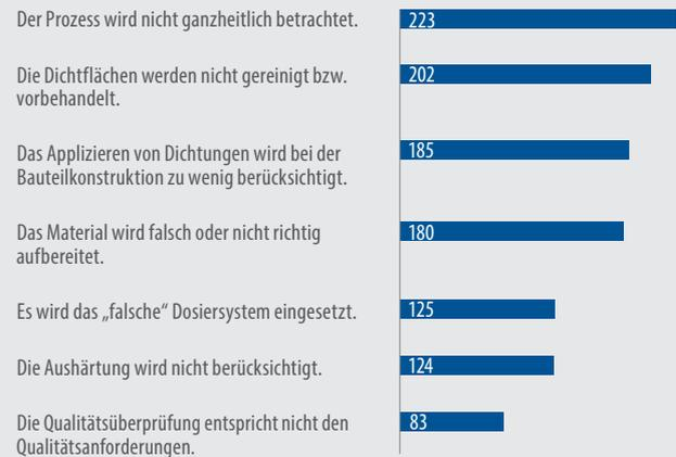
**Bild 19: Die meisten Probleme werden hier durch die Vernachlässigung eines komplexen Prozesses verursacht, zweitens leider wieder durch das Thema „Reinigung und Vorbehandlung“ der Dichtflächen und drittens durch eine nicht applikationsgerechte Bauteilkonstruktion. Alle drei Themen sind Klassiker, für die es bewährte Lösungen gibt.** (Bild: ISGATEC GmbH)
