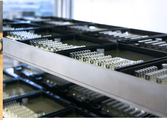
Bild 3: Vakuumverguss unterschiedlicher Steuerungen mit einer Vakuumzelle (Bild: Dipotec GmbH)
