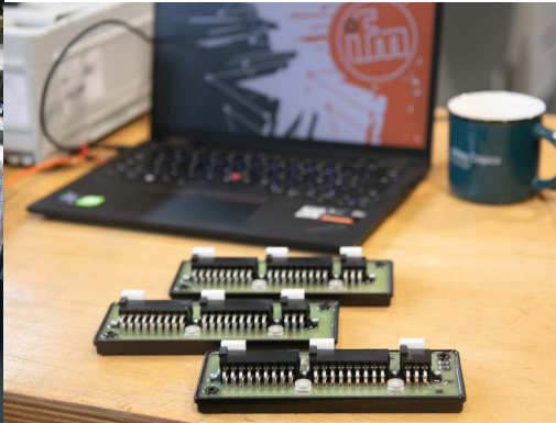
Bild 2: E/A-Module für mobile Arbeitsmaschinen – hier kommt es auf den perfekten Verguss an (Bild: Dipotec GmbH)
