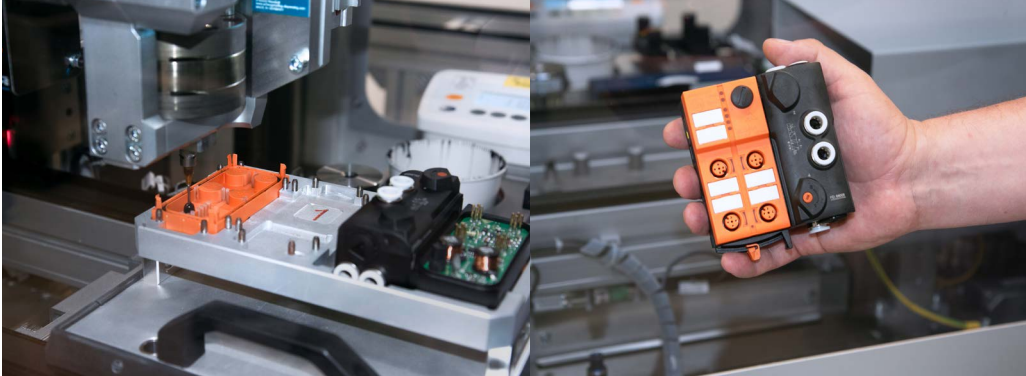
Bild 4: Material-Auftrag in der Produktion von Interfacemodulen mit der Dosier-Multifunktionszelle CNCell (links), rechts das fertige Bauteil (Bild: Atlas Copco EPS)
