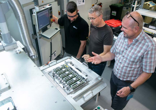
Bild 1: Ramp-up Support: Leo Gindele und Lothar Gschwind von ifm ecomatic besprechen das Vakuum-Vergussergebnis von E/A-Modulen für mobile Arbeitsmaschinen mit Alessandro Vogl von dipotec (Bild: Dipotec GmbH)
