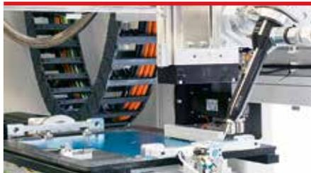
Ein Trend ist die Miniaturisierung der zu vergießenden Bauteile – hier das Dosieren auf der Leiterplatte (Bild: bdtronic GmbH)
