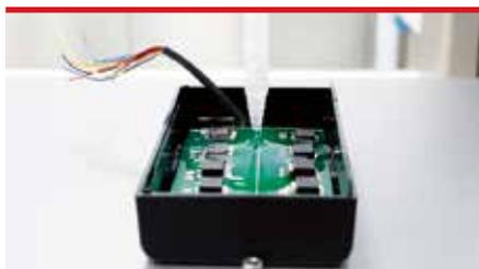
Verguss ist bei dynamischen Branchenentwicklungen auch immer ein Optimierungsthema (Bild: ViscoTec Pumpen- u. Dosiertechnik GmbH)
