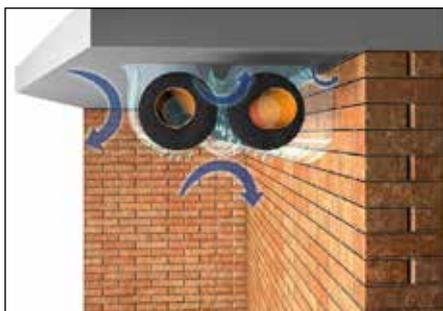
**Bild 2: Keine Luftzirkulation: Wenn Stauzonen den konvektiven Wärmeübergang unterbinden, steigt das Tauwasserrisiko** (Bild: Armacell)
