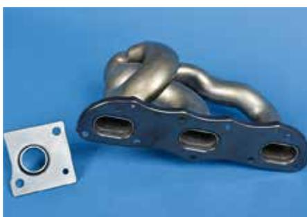
**Bild 3:** Dichtflansch eines Auspuffkrümmers – dicht mit Gleiteigenschaften bei Temperaturen bis zu 340 °C. Die multislide® Beschichtung verhindert Spannungsrisse im Leichtbaukrümmer sowie metallisches Verschweißen zwischen den metallischen Oberflächen und ist dicht. Der Reibungskoeffizient liegt bei 0,12 (Bild: acs Coating Systems GmbH)
