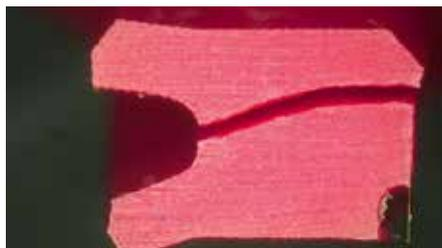
**Bild 2:** Mechanische Zerstörung einer TPU-Dichtung durch Hydrolyse und eine hohe physikalische Beanspruchung (Bild: O-Ring Prüflabor Richter GmbH)
