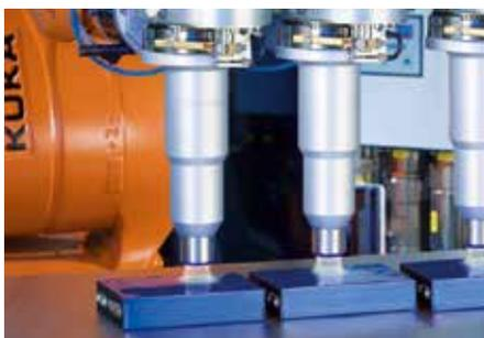
**Bild 2: Vorbehandlung von prismaischen Zellen. Die Reinigung und Aktivierung schaffen die Voraussetzungen für eine präzise Klebeverbindung mit optimalen Haftungseigenschaften**
