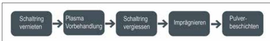
**Bild 2: In der Kombination verschiedener Prozesse in einer Großserienanlage liegt ein erhebliches Effizienzpotenzial** (Bild: bdtronic GmbH)
