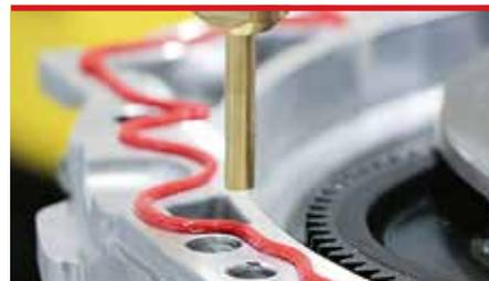
Dosierung eines Getriebedichtstoffes (Bild: DREI BOND GmbH)
