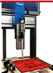
Volumetrische Kolbendosierer nach dem Verdrängungsprinzip können große Mengen in geringer Zeit applizieren (Bild: Nordson Deutschland GmbH)
