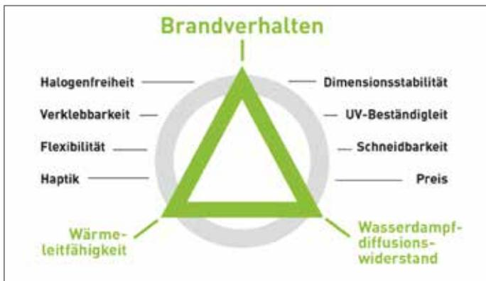
**Bild 2: Dämmstoffe müssen je nach Einsatzgebiet komplexe Zielkonflikte lösen**
