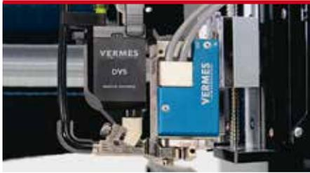
Das neue „DVS“ zur Dosiermengenmessung im nI-Bereich (Bild: VERMES Group)
