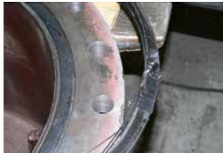
**Bild 2: Nicht empfehlenswert: Sicherung von Spiraldichtungen mit Klebeband**
