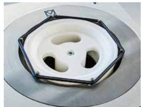
Bild 2: Aufweitung und Montage per kinematischer Rotation (Bild: Ohrmann GmbH)
