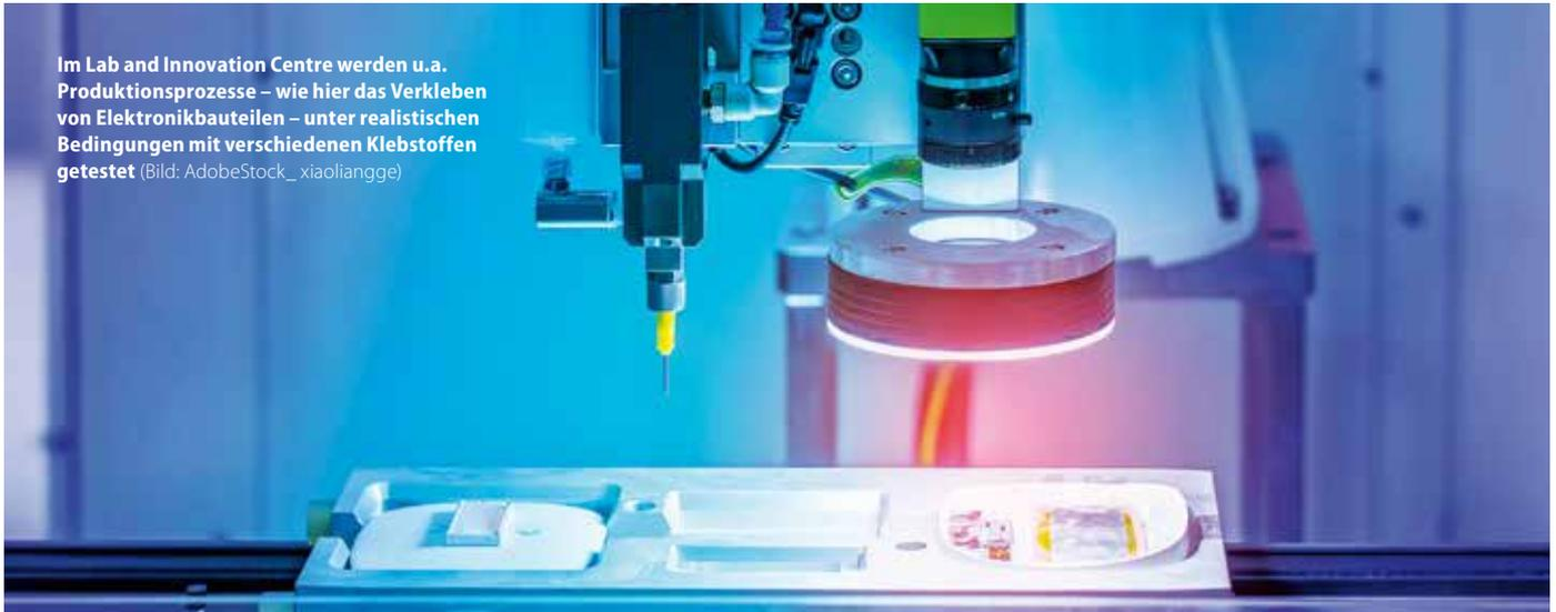
Im Lab and Innovation Centre werden u.a. Produktionsprozesse – wie hier das Verkleben von Elektronikbauteilen – unter realistischen Bedingungen mit verschiedenen Klebstoffen getestet (Bild: AdobeStock\_xiaoliangge)
