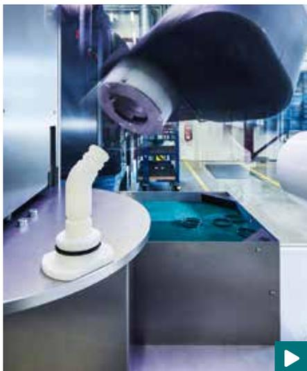
**Bild 3: Dichtungsmontage auf einem Bauteil, die bisher nicht möglich war. Rechts: Da die Aufweittechnik innen frei ist, können Dichtungen auch bei tiefen Nutlagen und gebogenen Bauteilgeometrien montiert werden (Bild: Ohrmann GmbH)**
