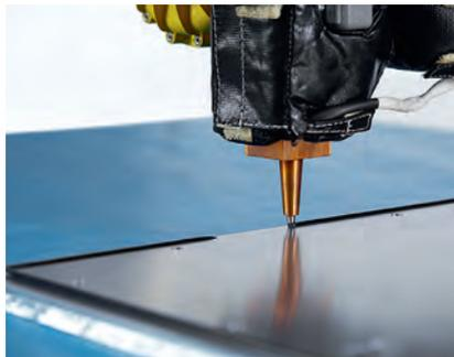
**Bild 5: Auf dem Gehäuserand applizierte Flüssigdichtung** (Bild: Atlas Copco)
