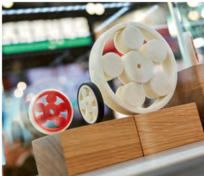
**Bild 3:** Ein Beispiel für additiv gefertigte Zwei-Komponenten-Funktionsbauteile – ganz ohne Montage – sind Planetenrollen aus TPU und PHA (Arboblend).
