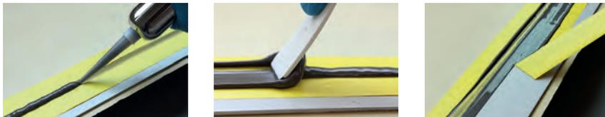
**Bild 2: Manuelle Dichtstoffverarbeitung mit Materialauftrag, Formgebung und Demaskierung**
