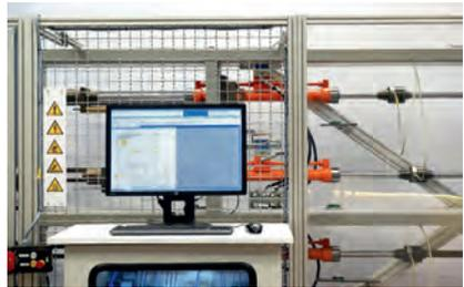
**Bild 1: Dichtungsprüfstand, um das Zusammenspiel von Dichtungs- und Führungssystemen mit Gegenaufläichen zu prüfen (Bild:**
