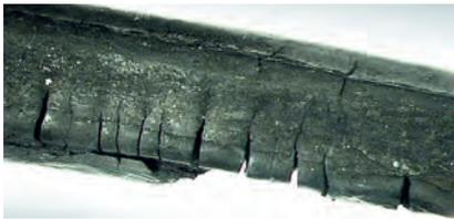
**Bild 1: Thermische Zersetzung einer Dichtung**
