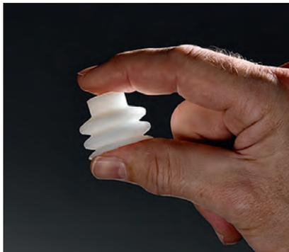
**Bild 4:** Das AKF-Verfahren eignet sich für TPE-Werkstoffe verschiedenster Härten Shore A. Der Freeformer fertigt daraus additiv z.B. funktionsfähige, luftdichte Faltenbälge.
