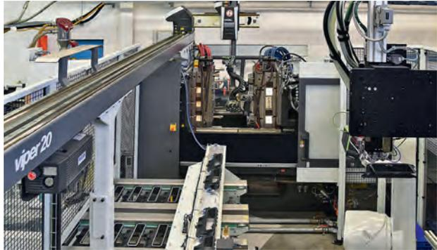
len Industrien eingesetzte FIPFG-Dichtungstechnologie ermöglicht es, Dichtungsmaterial in einem vollautomatischen Applikationsprozess direkt auf Bauteile konturgenau aufzutragen, wo sie zur Schaumdichtung bei Raumtemperatur ausreagiert.
