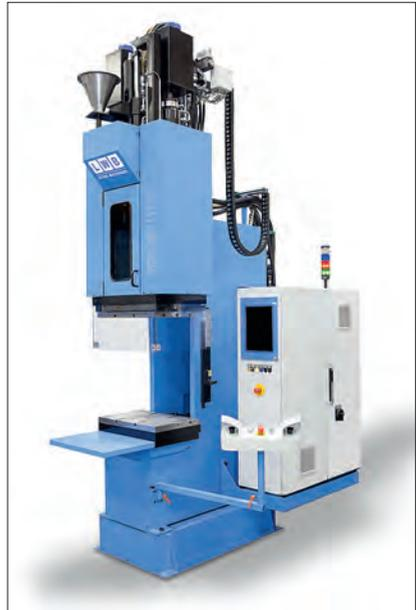
**Bild 4: Die Prozessstabilität der neuen TPE-Technologie für 2K-Anwendungen mit EPDM wurde auf einer Vertikalmaschine erprobt und optimiert**
