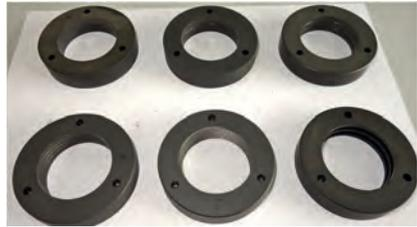
**Bild 7: Ringe mit verschiedener Nutausführung und -anzahl für Leckageuntersuchungen**
