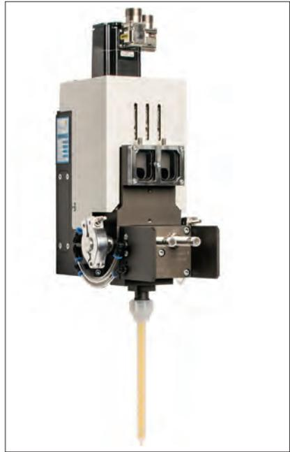
**Bild 7: Der robuste und vielseitig einsetzbare Dos P016 sorgt dank seiner exakt dimensionierten Dosierzylinder für die Ausbringung präziser, reproduzierbarer Materialvolumina bzw. ein jederzeit konstantes Mischungsverhältnis bei 2K-Materialien**
