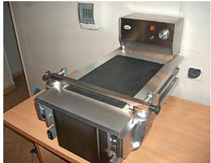
**Bild 3: Laborbeschichtungsvorrichtung mit Granitplatte** (Bild: Westpommersche Technische Universität Szczecin)
