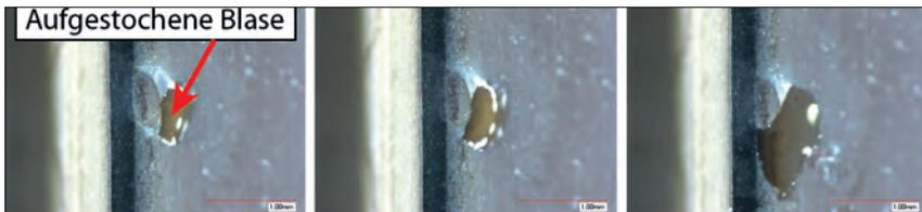
**Bild 9: Öl-Ausfluss nach dem Aufstechen der Blase aus Bild 8 zu verschiedenen Zeitpunkten** (Bild: Universität Stuttgart, Institut für Maschinenelemente (IMA))
