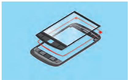
**Bild 2: Display-Fixierung – schmale Stanzteile müssen fest kleben und Stöße dämpfen**
