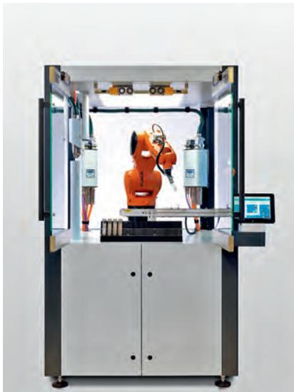
**Bild 10: Die schlüsselfertige, vollautomatische Plasmazelle PTU1212 beinhaltet alles, was der Plasmaprozess verlangt und kann an jede handelsübliche Spritzgussmaschine angeschlossen werden** (Bild: Plasmatrete GmbH)
