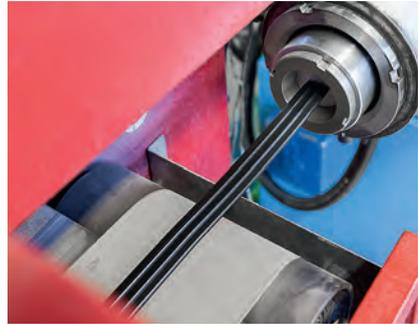
**Bild 1: Extrusion eines Dichtungsprofils aus dem neuen Festsilikonkautschuk**
