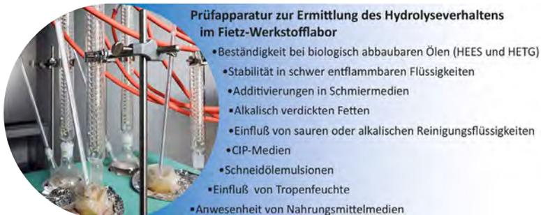
**Bild 4: Prüfapparatur zur Ermittlung des Hydrolyseverhaltens im Werkstofflabor**
