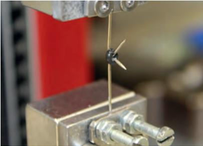
**Bild 5: Zugversuch eines Mikro-O-Ringes mit speziellen Nadeln als Probehalter**
