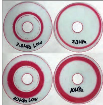
Bild 7: Film-Aufnahmen verdeutlichen die Pressungsverteilung (Bild: Frenzelit GmbH)
