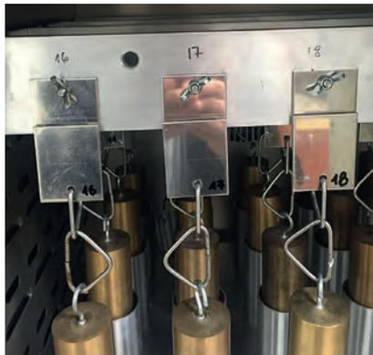
**Bild 5: Kohäsionsbestimmung von Transfer-Haftklebebändern** (Bild: Westpommersche Technische Universität Szczecin)
