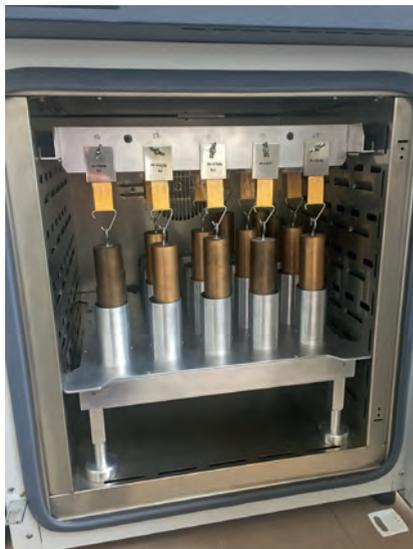
**Bild 4: Kohäsionstest von einseitigen oder doppelseitigen Haftklebebändern**
