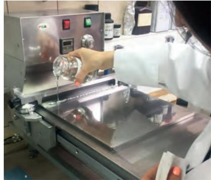
**Bild 2: Laborbeschichtungsvorrichtung im Einsatz** (Bild: Westpommersche Technische Universität Szczecin)
