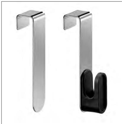
**Bild 3: Der Metallkörper (links) kann sofort nach der Beschichtung im Atmosphärendruckplasma mit dem Thermoplast-Compound (rechts) überspritzt und zum festen Verbund gebracht werden** (Bild: Plasmatrete GmbH)
