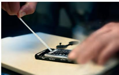
**Bild 3: Mit der Verwendung von Tapes lassen sich Akkus leichter wechseln** (Bild: tesa SE)
