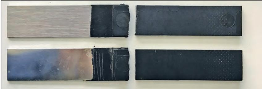
**Bild 6:** Auch nach zwölf Monaten Freibewitterung kommt es bei den PST-beschichteten Aluminium- und Edelstahl-Prüfkörpern zum gewünschten kohäsiven Bruch im Kunststoff
