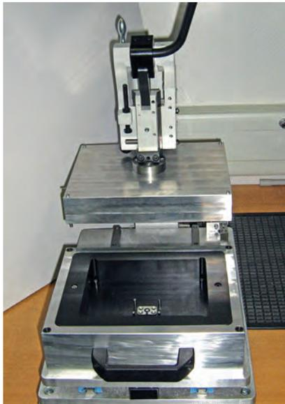
**Bild 3: Vorrichtung zum Prüfen eines Displaysystems in einer Haube – hier ist die leere Haube dargestellt**
