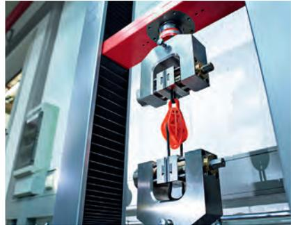
**Bild 5: Komplett Bauteilgruppe im bereits montierten Zustand additiv gefertigt: Eine über Gelenke bewegliche Seilrolle aus Bio-Polyamid mit Gehäuse und Befestigungshaken ist mit 100 kg belastbar**
