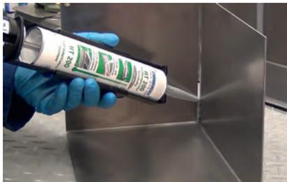
**Bild 4: MS-Polymere, wie Flex 310 M HT 200, sind – anders als Silikone – für den Einsatz von konstruktiven Verbindungen prädestiniert**
