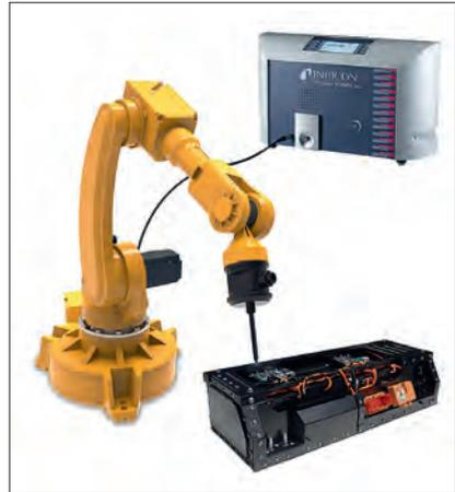
**Bild 1: Dynamische Roboter-Schnüffellecksuche an einem Batteriegehäuse** (Bild: INFICON)
