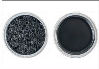
**Bild 4:** Links: mit Feuchtigkeit versetztes, aufgeschäumtes PU, rechts: korrekt unter Vakuum aufbereitetes und vergossenes PU
