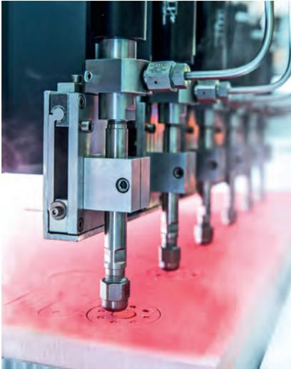
**Bild 5: Der gleichzeitige Betrieb mehrerer Schneidköpfe erhöht die Effizienz der Anlagen**
