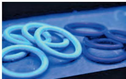
**Bild 6: Um den Anwendern die beruhigende Sicherheit über den ordnungsgemäßen Zustand der Dichtungen zu geben, schließen sich nach dem Beschichtungsprozess zahlreiche Prüfungen an.**
