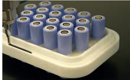
**Bild 5: Raupenauftrag für strukturelle Verklebung mit gleichzeitigem Abdichten** (Bild: ViscoTec Pumpen- u. Dosiertechnik GmbH)
