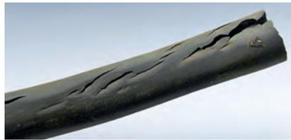
**Bild 2: Durch chemischen Angriff zerstörte Dichtung** (Bild: C. Otto Gehrckens GmbH & Co. KG)
