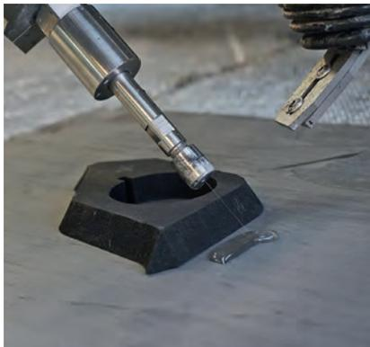
**Bild 1: Die Wasserstrahlsteuertechnik bietet sich heute für die Fertigung vieler Dichtungs- und Formteillösungen an**
