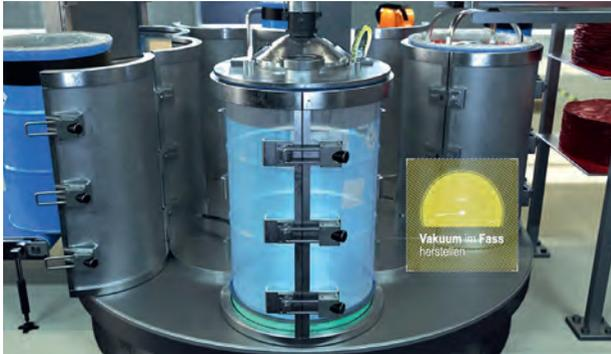
**Bild 4: Vollautomatisierte Komplettlösung mit antriebenem Rondell, auf dem jeweils vier Fässer im Kreisverkehr positioniert, befüllt und versiegelt werden**
