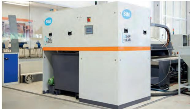
Schneidgeschwindigkeit – bis zu 55% des gebrauchten Abrasivs wiederverwendbar. Der benötigte Energieaufwand für die Wiederaufbereitung des Abrasivs ist mit 3 bis 6 kW minimal. Die Schnittqualität bleibt im Vergleich zu neuem Abrasiv gleich. Das Abrasiv Recycling ist eines von fünf zueinander in Beziehung stehenden Modulen des OneClean-Systems. Die Anlage kann also mit einem kleinen Investment in Betrieb gesetzt und nach Bedarf jederzeit erweitert werden.
