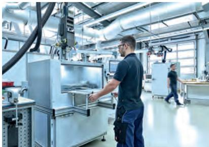
**Bild 5:** Mit professionellem Equipment und einem Team aus Vergussexperten können im Technologie- und Anwenderzentrum des Systemanbieters praxisgerechte Lösungen entwickelt werden – hier der Verguss unter Vakuum (Bild: Scheugenpflug AG)
