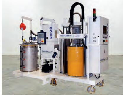
**Bild 1: Halbautomatische Vakuumstation für die luftfreie Abfüllung von 200-l-Deckelfässern, die sich für viele verschiedene pastöse und hochviskose Medien nutzen lässt und auch auf andere Gebindegrößen auslegt werden kann** (Bild: Tartler GmbH)
