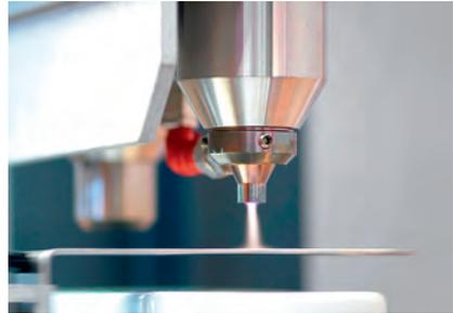
**Bild 1:** Mit dem chemisch-physikalischen Plasma-SealTight-Verfahren lassen sich in Millisekunden funktionelle Nanoschichten ortsselektiv abscheiden und in der Folge stoffschlüssige Verbindungen unterschiedlicher Materialien erzeugen (Bild: Plasmatrete GmbH)
