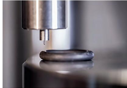
**Bild 6: Härteprüfung an einem O-Ring (Methode IRHD, CM)**
