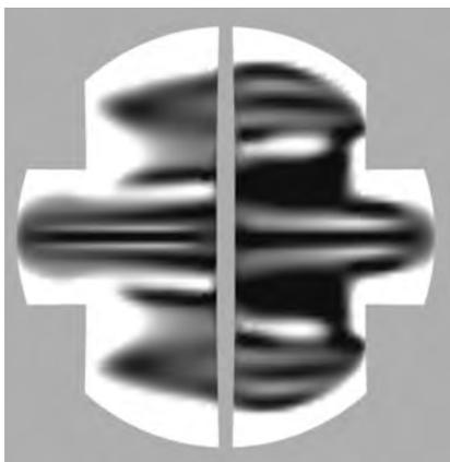
**Bild 5: Unschärfe Felder sind das Ergebnis numerischer Diffusion bei klassischen CFD-Methoden** (Bild: Sulzer Mixpac Ltd.)
