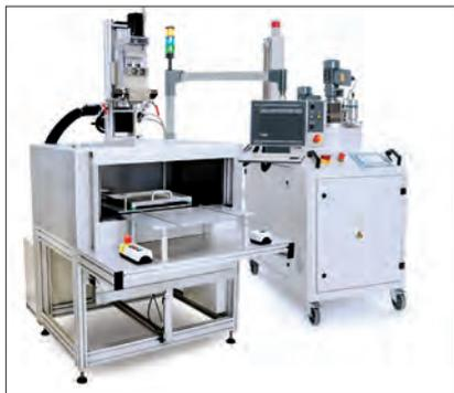
**Bild 6:** Das Vakuumdosiersystem VDS U (hier mit Aufbereitungs- und Förderanlage A310) eignet sich aufgrund seiner drei Verfahrenen für den Verguss mehrerer Teile in einem Durchgang sowie bei schwierigen Bauteilgeometrien und komplexen Vergussprogrammen
