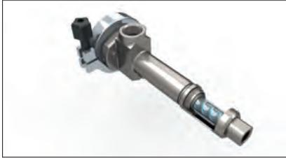
**Bild 1: Exzentrerschneckentechnologie: Jede einzelne Dispenserkammer fördert ein exakt definiertes Medienvolumen und dient gleichzeitig als Dichtlinie in Richtung Pumpeneingangs- und ausgangsseite**
