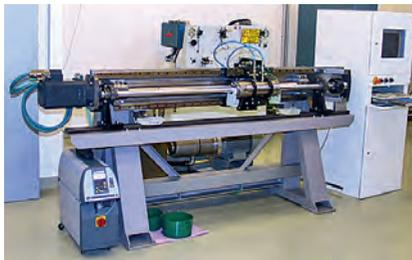
**Bild 5: Kolbenstangen-Linearprüfstand**
