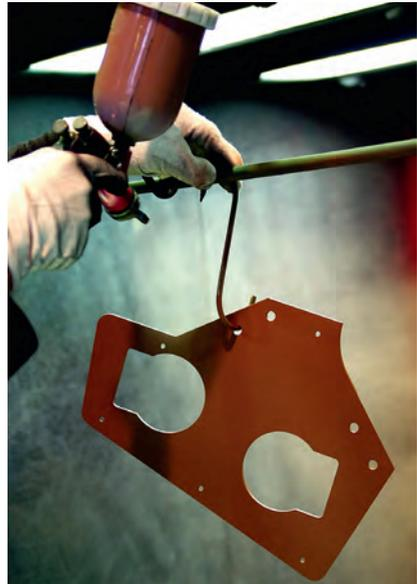
**Bild 2: Auswahl mit Augenmaß:** Bei einer Lackapplikation ist die Erreichbarkeit aller zu beschichtenden Oberflächen des Bauteils mit einer Lackpistole unverzichtbar
