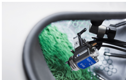
Bild 2: Mit neuer Sensorik und einem elektropneumatischen Ventil regelt man den Volumenstrom der Sprühmedien präzise (Bild: Walther Trowal GmbH & Co. KG)
