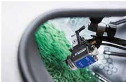
**Bild 2:** Sprühpistolen verteilen das Beschichtungsmaterial homogen auf der Oberfläche der Elastomerteile (Bild: Walther Trowal GmbH)
