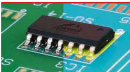
Structalite® 5751 als Underfill unter normalem (li.) und unter UV-Licht (re.) im Vergleich (Bild: Panacol)
