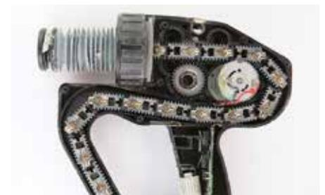
**Bild 3:** Die Kettenschubstange erlaubt eine deutlich kompaktere Bauweise als andere Akku-Kartuschenpressen, da sich die Schubstange im Griff windet
